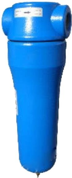
Влагоотделители для компрессора представляют из себя колбу, в которой воздух резко закручивается, под действием центробежной силы капли конденсата отбрасываются на стенки сосуда и стекают на дно сепаратора. За принцип работы такие влагоотделители получили название центробежных или циклонных. Скопившейся на дне конденсат может быть удален через ручной клапан слива (в стандартной комплектации) либо с помощью клапанов автоматического типа.
