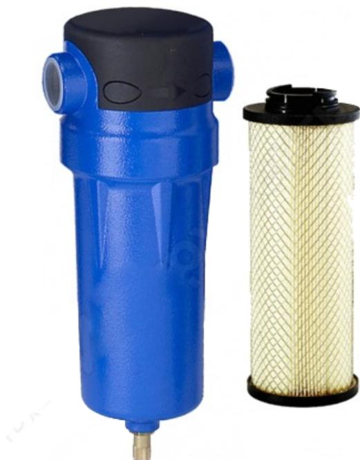
Фильтры предназначены для очистки сжатого воздуха от крупных твердых частиц и эмульсий размером до 5 мкм. Фильтры типа QF устанавливаются перед фильтрами тонкой очистки для защиты от быстрого загрязнения крупными частицами (атмосферная пыль, продукты коррозии трубопроводов, и т.д. )
